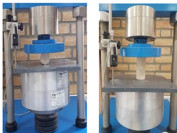
شکل ۲. نمونه های آزمایش UCS و ITS
