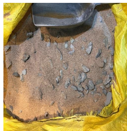
شکل ۱. تصویر ماسه ۱۶۱ فیروزکوه و مخلوط با ضایعات بتنی
