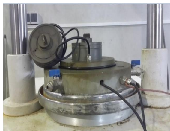
شکل ۵. دستگاه بندر المنت نصب شده در دستگاه سه محوری
