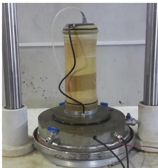
شکل ۶. نمونه آماده سازی شده برای آزمایش سه محوری
