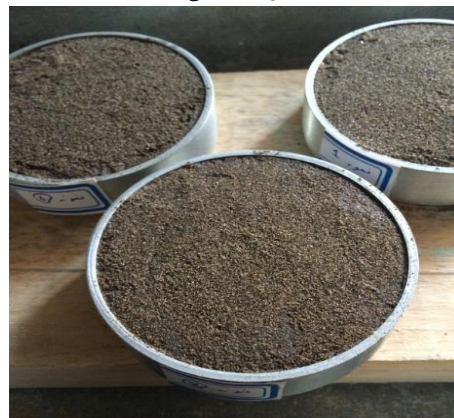
ج) نمونه‌ها بعد از ۷ روز عمل آوری شکل ۳. آماده سازی نمونه‌های آزمایش برش مستقیم
