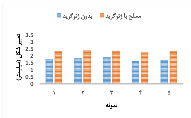
شکل ۱۳. تغییر شکل در نمونه مسلح و غیر مسلح
