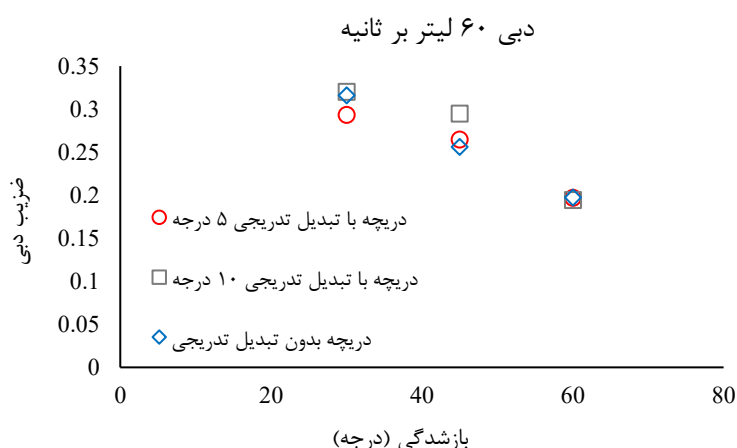
شکل ۷. تغییرات ضریب آبگذری نسبت به تغییرات بازشدگی دریچه
