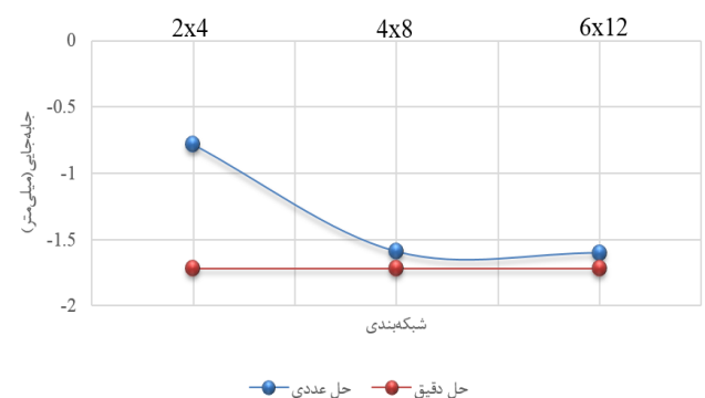
شکل ۱۶. همگرایی جابه‌جایی مرکز دال بتنی مستطیلی تحت بار متمرکز با تکیه‌گاه‌های گیردار
