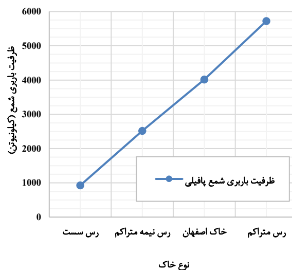
شکل ۶. مقادیر ظرفیت باربری شمع پافیلی در خاک‌های متفاوت
